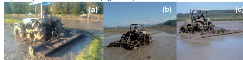
Figura 15. Implementos utilizados no preparo final do solo: enxada rotativa (a), grade (b) e prancha com alisador (c).
