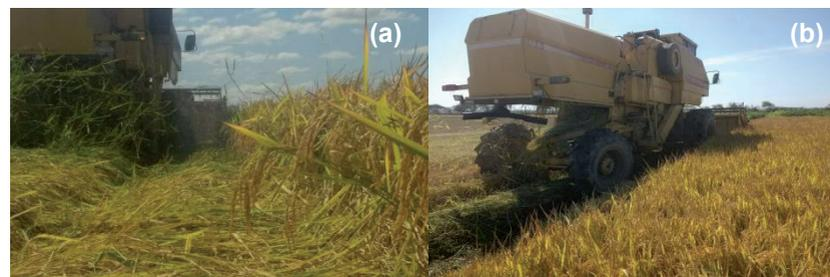
Figura 4. Colheitadeira em operação, com (a) e sem (b) uso de picador/espalhador de palha.
