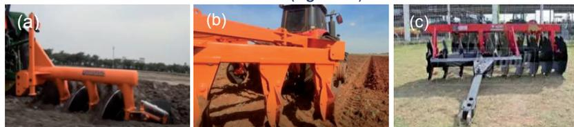
Figura 13. Implementos utilizados no preparo inicial do solo: arado de disco (a), arado de aiveca (b) e grade aradora (c).
